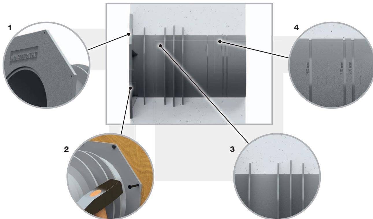
1. Bride de raccordement placée côté eau avec surface rugueuse antidérapante pour le raccord de matériaux d'étanchéité extérieurs.
