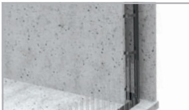
Le montage des profilés de joint de retrait SFE dans la zone angulaire des éléments de mur creux s'effectue selon le même modèle. La géométrie des onglets de retenue est optimisée pour un montage dans des zones angulaires.
