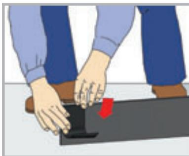
Pose de la bande adhésive dans la zone où deux tôles doivent être raccordées. Une bande adhésive doit être posée sur les deux tôles.
